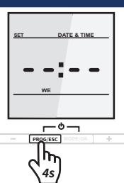
Drücken und halten Sie die **PROG/ESC** Taste für 4 Sek.Press and hold **PROG/ESC** button for 4 seconds.Appuyez sur la touche **PROG/ESC** pendant 4 secondes.
