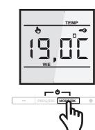
Bestätigen Sie diesen Vorgang mit der **MODE/OK** Taste, sodass der Thermostat in den zuvor gewählten Betriebsmodus wechselt oder wählen Sie beide Sensoren **A** und **F** mit Hilfe der „+“ oder „-“ Tasten aus.
