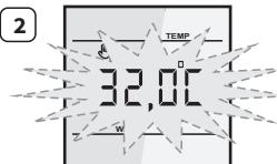
Die Bodentemperatur mit Hilfe der „+“ oder „-“ Taste einstellen.
