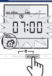
Drücken Sie die **MODE/OK** Taste. Die Uhrzeit beginnt zu blinken.Press the **MODE/OK** button. The clock time will start to blink.Appuyez sur le bouton **MODE / OK**. L'heure commence à clignoter.
