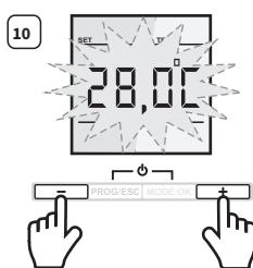
Stellen Sie die gewünschte Raumtemperatur ein. Wird diese Raumtemperatur erreicht wird die Heizung unabhängig von der Bodentemperatur abgeschaltet.
